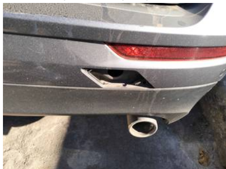
Bouclier arrière (Défaut aspect)
