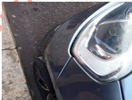
Bouclier avant (Défaut aspect)
