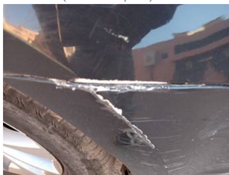
Bouclier avant (Défaut aspect)
