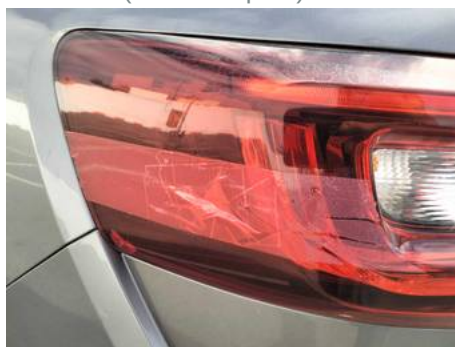
Phare arrière gauche (Défaut aspect)
