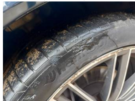
Pneu avant droit (Usure 50%)
