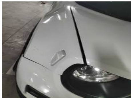
Aile avant droite (Défaut aspect)
