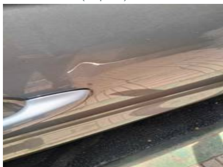
Porte avant droite (Impact)
