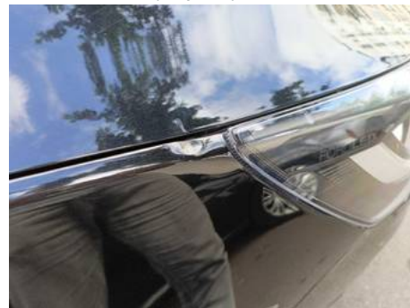
Aile avant droite (Impact)
