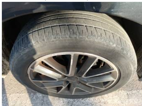
Pneu avant droit (Usure 75%)
