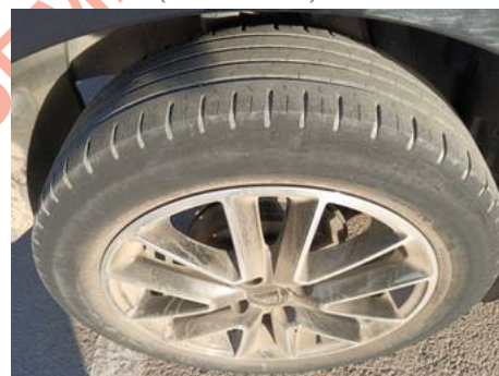
Pneu arrière droit (Usure 50%)
