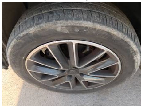
Pneu avant droit (Usure 75%)
