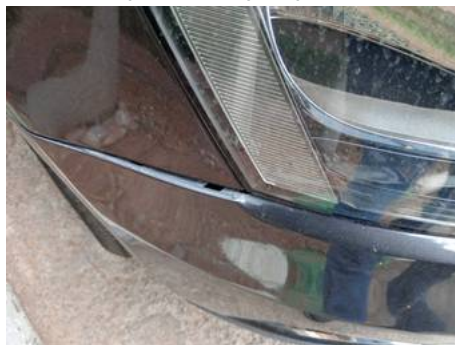
Bouclier avant (Défaut aspect)
